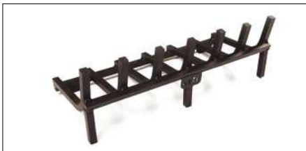
Ενισχυμένη σχάρα από μασίφ σίδηρο 16x16mm, με κλίση προς τα πίσω έτσι ώστε να αποτρέπεται η κύλιση ξύλων προς την πόρτα.
