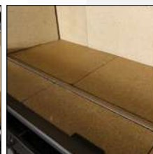
Καυστήρας με αεροκουρτίνα, βερμικουλίτη και δευτερογενή καύση
