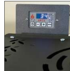
Ηλεκτρονικός θερμοστάτης με αυτόματη και χειροκίνητη λειτουργία
